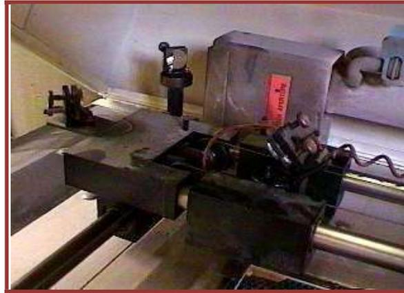
الشكل (12-5) عدسات ومرايا تستعمل لتوجيه شعاع الليزر.
