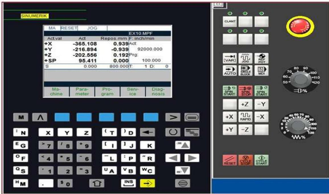
الشكل (1-3) يوضح لوحة السيطرة نوع SIEMENS SINUMERIC 802S M.
